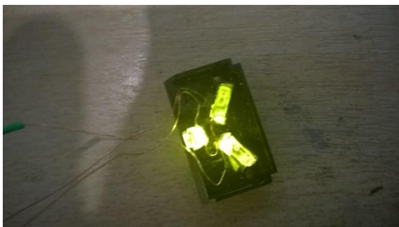
Front .sluit verlichting: SMD Led's op de onderbroken lichtgeleiders lijmen en testen...
