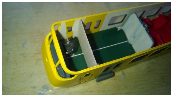
Bodem van de motorloze bak dicht gemaakt en cabine afscheiding inmeten...
