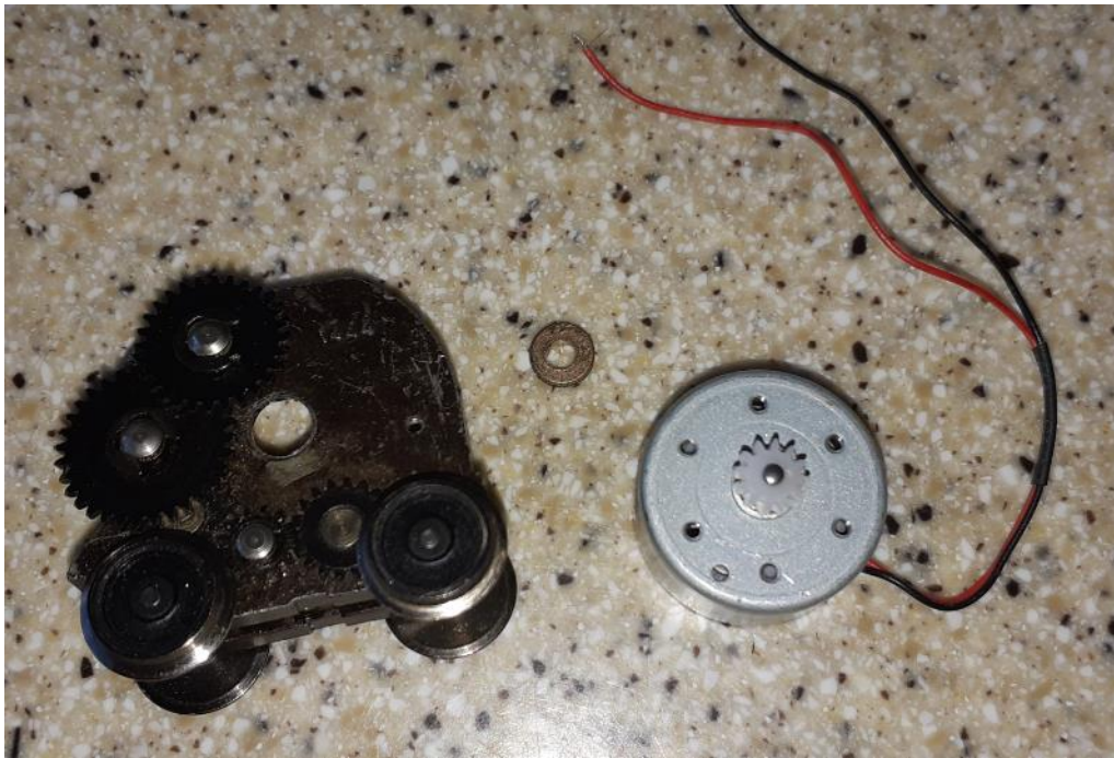
Draaistel ontdaan van Fleischmann rondmotor, lager uitgeboord en Modeltorque motor los...
