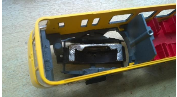
Dummy motor afgezaagd en inpassen in bestaande metalen motor frame van de rijtuigbak...
