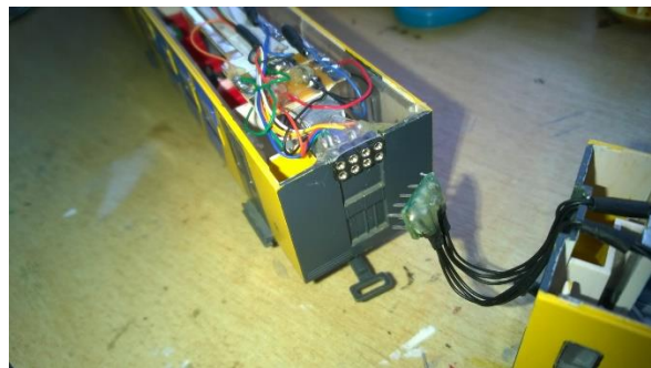
Female connector vast gelijmd en male connector van trekontlasting voorzien. Verbinding bestaat uit 2 bosjes van 4 draden...
