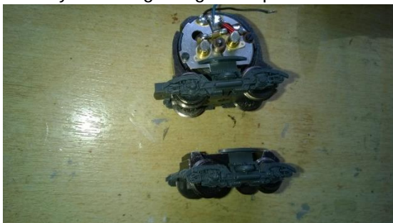
Motor en dummy draaistel ontdaan van koppeling schacht, ATB spoelen moeten er nog op komen...
