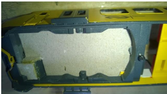
Bodem van de motorloze bak dicht gemaakt en cabine afscheiding inmeten...
