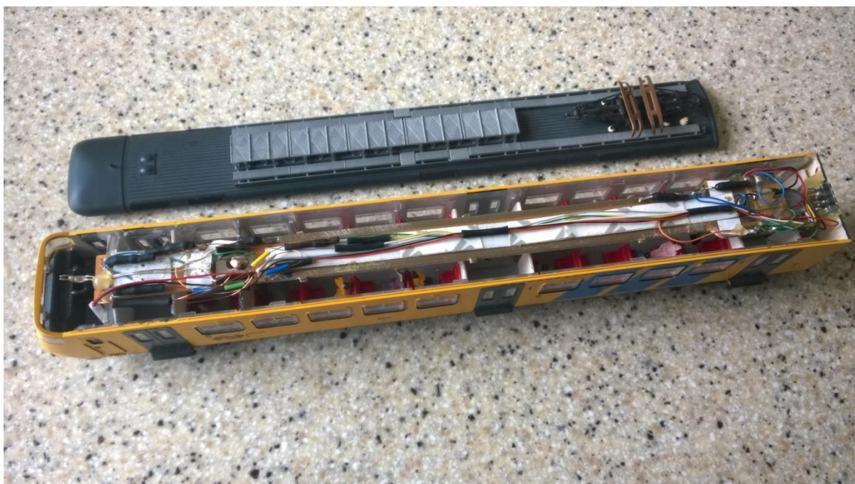
Motorloze bak compleet met extra interieur en bedrading afgemonteerd (voordat het dak gesloten wordt...
