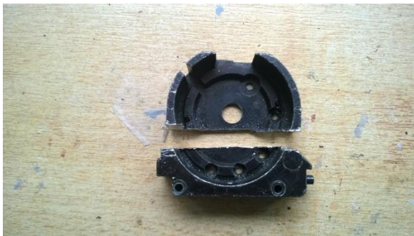
Dummy motor afgezaagd en inpassen in bestaande metalen motor frame van de rijtuigbak...
