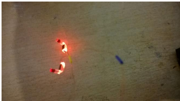
Front .sluit verlichting: SMD Led's op de onderbroken lichtgeleiders lijmen en testen...
